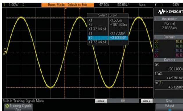
Figura 1: O sinal senoidal ensina aos estudantes como ajustar a escala de formas de onda para otimizar a visualização em tela, como utilizar o gatilho nos cruzamentos de bordas e como fazer medições básicas de tensão e tempo.
